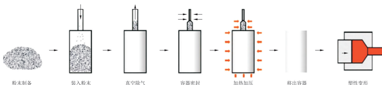
图 1 粉末冶金制备 Al-Li 合金流程图 [4]
